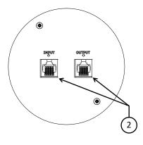
LABELED INPUT AND OUTPUT PORTS ARE FOR CABLE IDENTIFICATION ONLY - PORTS ARE ELECTRICALLY IDENTICAL & CAN BE INTERCHANGED.
